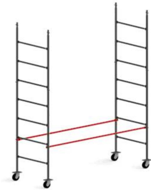
4. Додаються діагоналі з зовнішнього боку конструкції, максимально затягуються болти.
